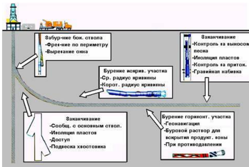
Рис. 2. Схема бурения боковых стволов
