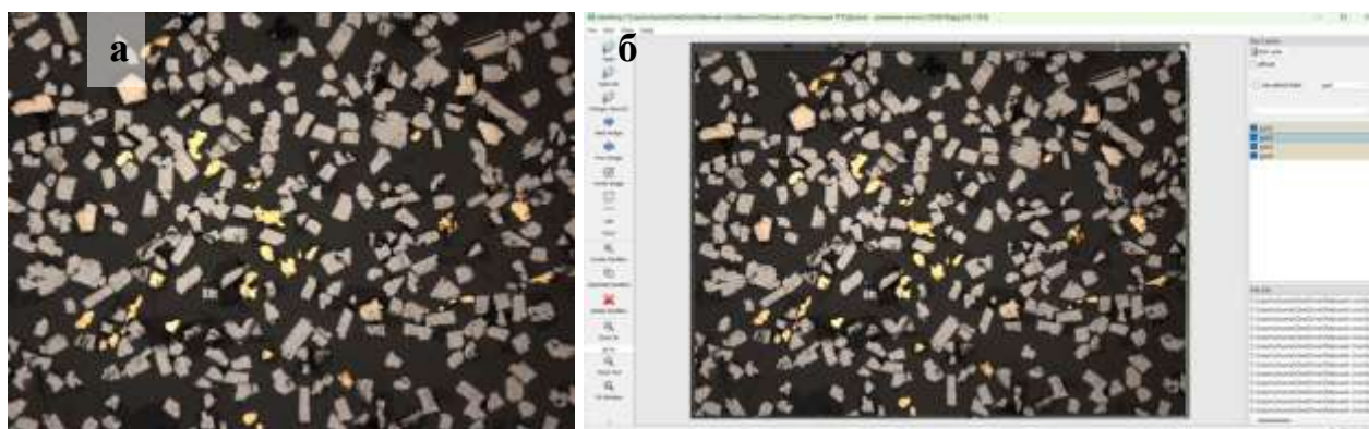
Рисунок 2. Аннотирование частиц золота на изображении в программе LabelIMG: а – исходное изображение, б – процесс аннотации.
