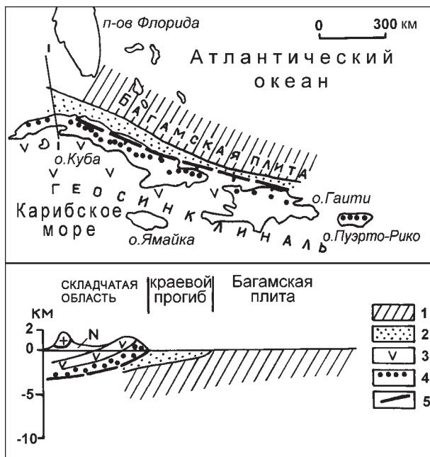
Рис. 3. Схема структуры (вверху) (по А.Ф. Адамович и В.Д. Чехович [1964]) и схематический геологический разрез по линии I—I (внизу) (составил Ю.В. Казанцев) района о-ва Кубы
