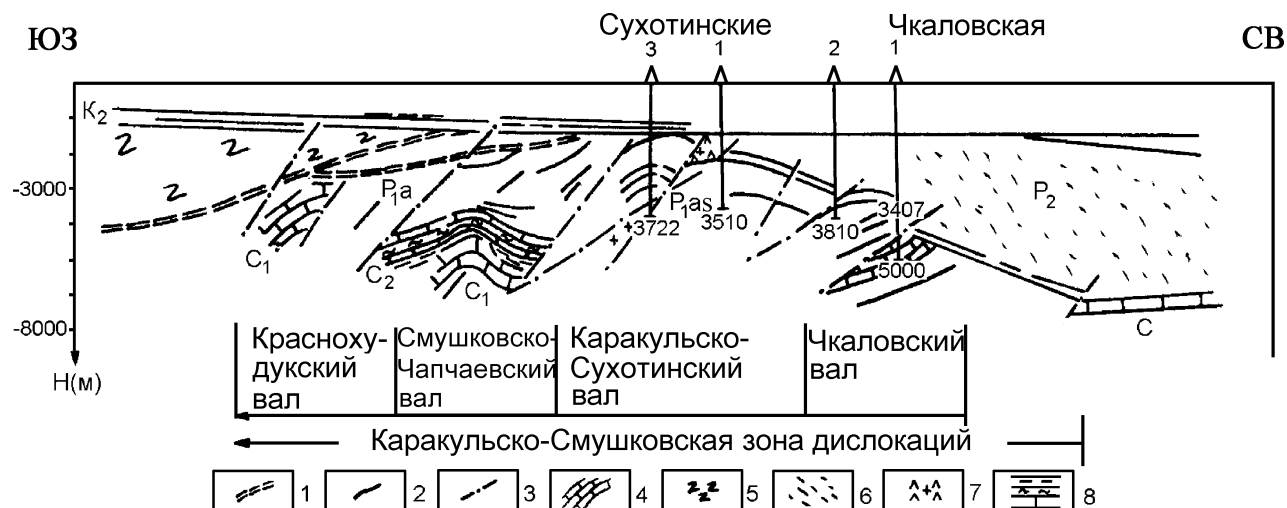
Рис. 10. Сейсмогеологический разрез через зону сочленения Восточно-Европейской и Скифской платформ. По В.Э.-Г. Бембееву, В.П. Климашину, С.С. Скрощкому [1985]
