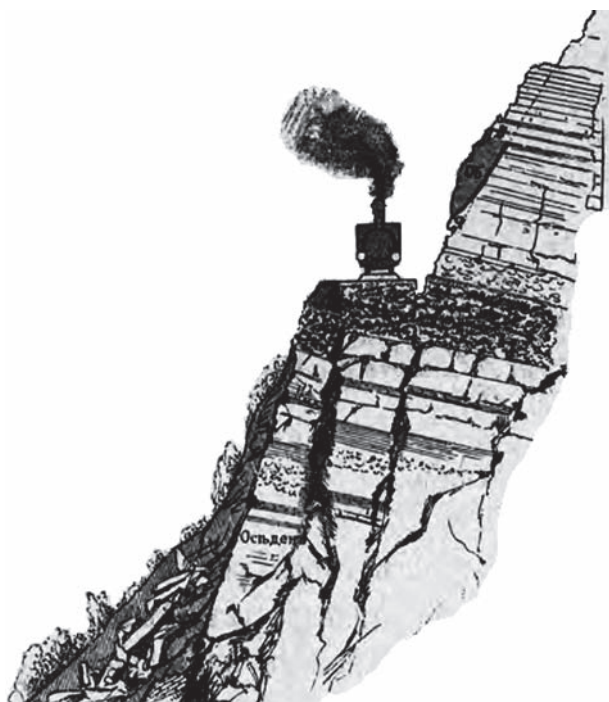
Рис. 3. Трещины бортового отпора, играющие решающую роль в формировании карста Уфимского косогора «Черт. 17. Разрез через обвал» (по Д.Л. Иванову [1899])
