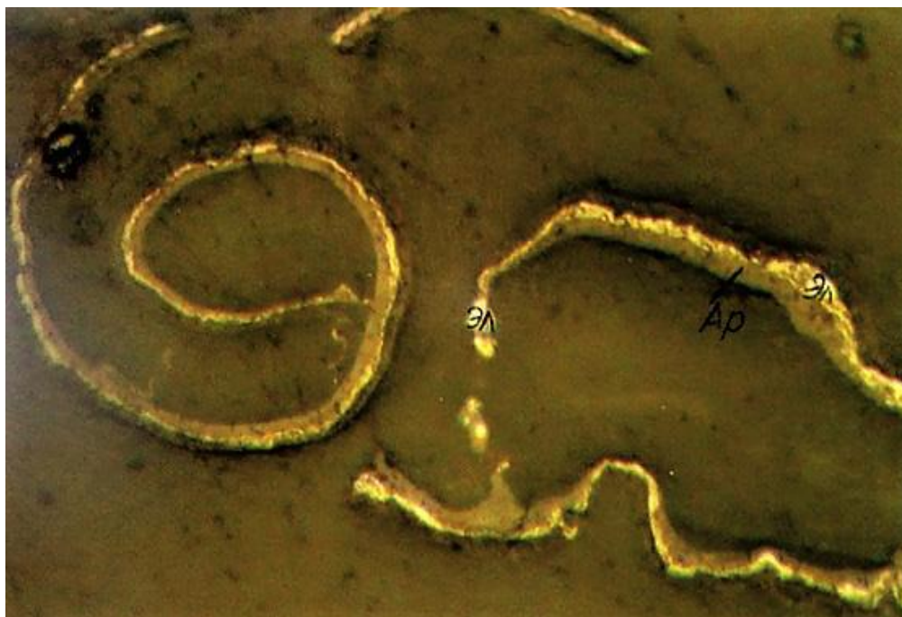
Рис. Высокосеребристые золотины в массе окисленных пород в отвале вскрыши Учалинского карьера под бинокулярным микроскопом
