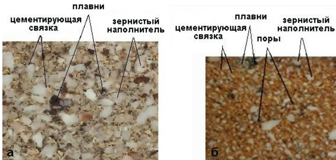
Рис. 2. Структура сколов образцов композиционных материалов из пирофиллитового сырья месторождения Куль-Юрт-Тау, изготовленных с применением силикатного связующего (а) и фосфатного связующего (б)
