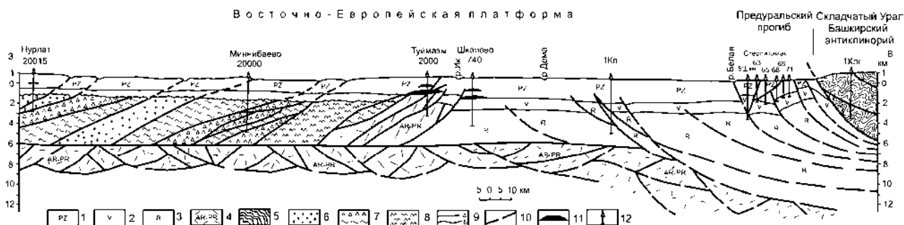
Рис. 1. Геологический разрез от Урала до южной части Татарского свода (По М.А. Камалетдинову и автору)
