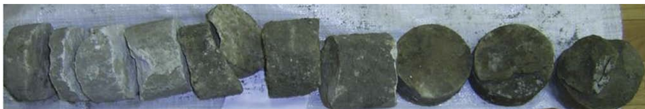
Рис. 2. Привятская площадь. Сква. А. Песчаник нефтенасыщенный, мощностью 1.7 м, переходящий в водоносный, ардатовский горизонт
