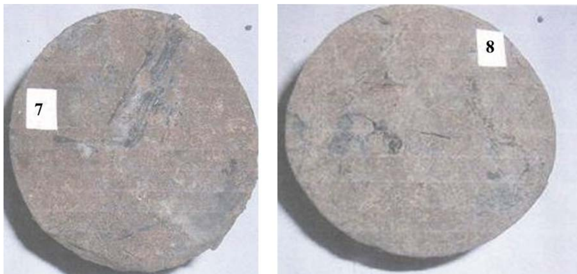
Рис. 3. Скв. А, инт. 1690,0–1695,0 м, ардатовский горизонт, песчаник нефтенасыщенный, с многочисленными ОРО, включениями пирита
