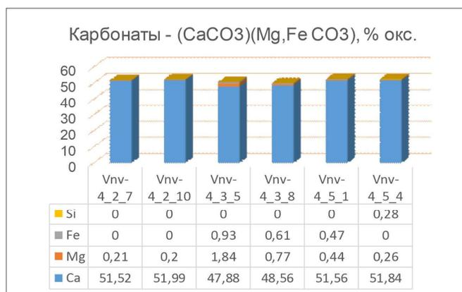
Рис. 3. Петрографический состав пород карбонатного массива Вансвик
