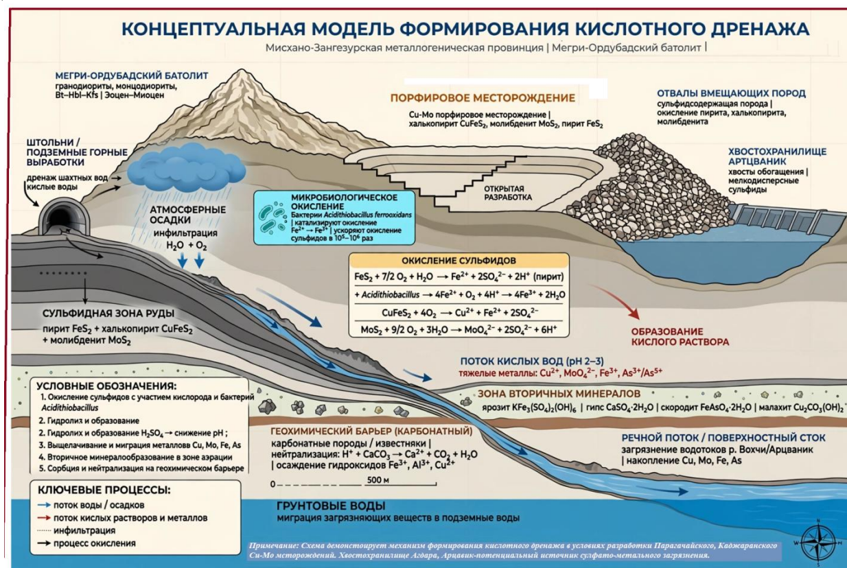
Рис. 1. Концептуальная модель формирования кислотного дренажа и путей миграции тяжелых металлов в природных геосистемах Мисхано-Зангезурской металлогенической провинции.
