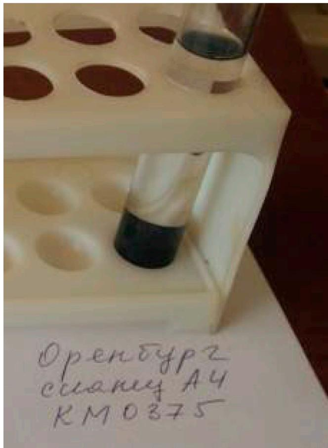
**Рисунок 4.3 – Результат экстракции хлороформенного битумоида из углеродистых сланцев Кумакского рудного поля.**
