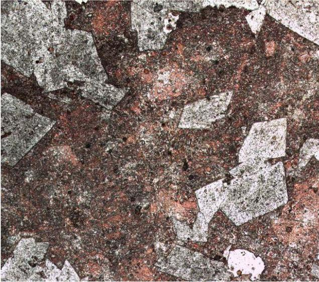
Рис. 7 Доломитизация известняка в прокрашенном шлифе с выключенным анализатором (размер изображения 2 мм)
