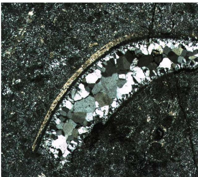
Рис.3 Окремнение органического остатка с включенным анализатором (размер изображения 2 мм)
