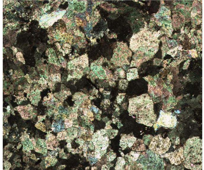
**Рис. 6** Гипидиоморфные кристаллы доломита с включенным анализатором (размер изображения 2 мм)
