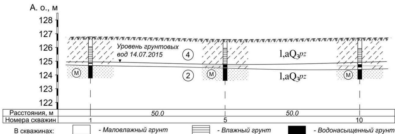
**Рис. 1. Инженерно-геологический разрез по линии скважин 1 – 5 – 10**
